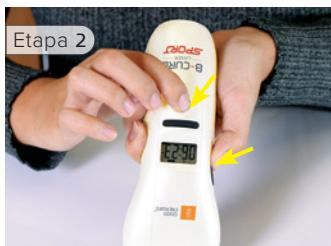
Continue a pressionar e, em simultâneo, pressione a área do interruptor de pressão, utilizando um outro dedo
